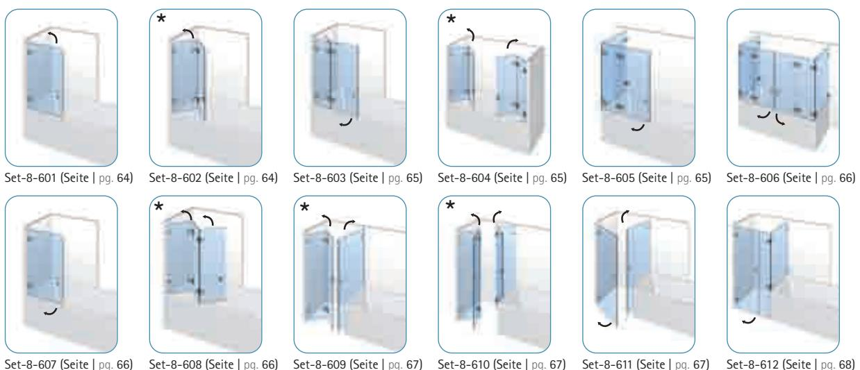
\*Bei diesen Flinter-Sets kann alternativ durch die Kombination mit Flamea-Duschtürbändern im Wandbereich die Faltwand nach innen und nach außen geklappt werden.
