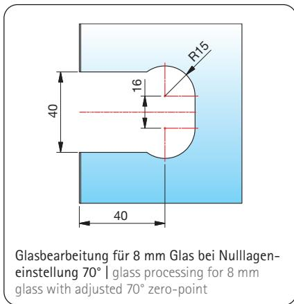
Glasbearbeitung für 8 mm Glas bei Nulllagen-einstellung 70° | glass processing for 8 mm glass with adjusted 70° zero-point
