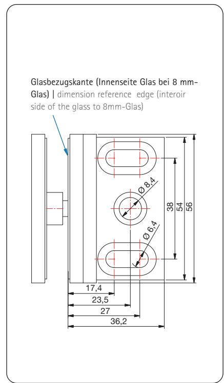
Glasbezugskante (Innenseite Glas bei 8 mm-Glas) | dimension reference edge (interior side of the glass to 8mm-Glas)
