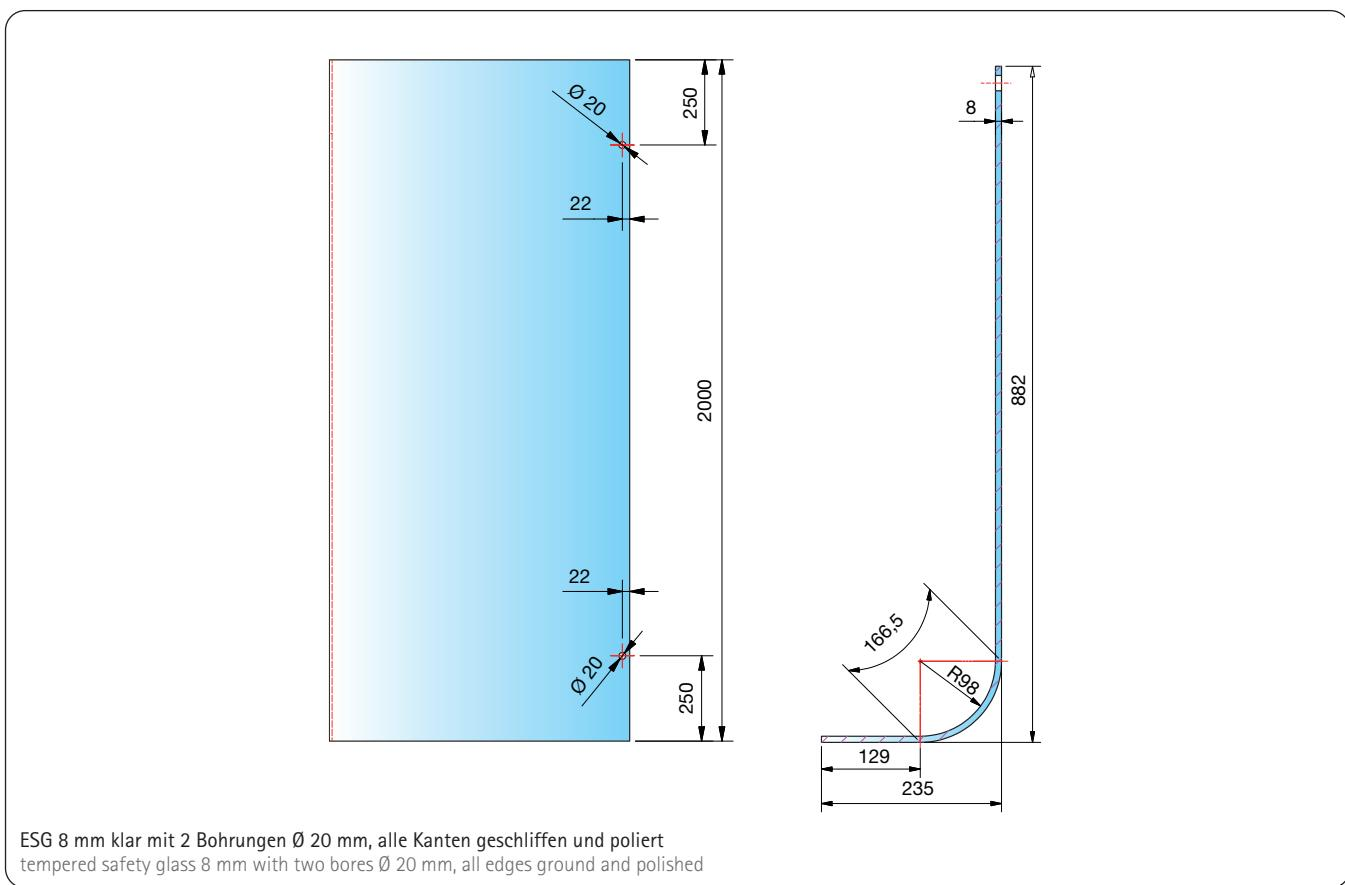
ESG 8 mm klar mit 2 Bohrungen Ø 20 mm, alle Kanten geschliffen und poliert
